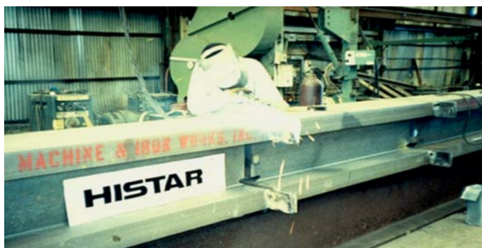
Abb. 9: Markenstahl Histar – Schweißen ohne Vorwärmen Abb. 10: TM-QST-Stähle – Markenstahl Histar bietet Optimierungspotenzial
