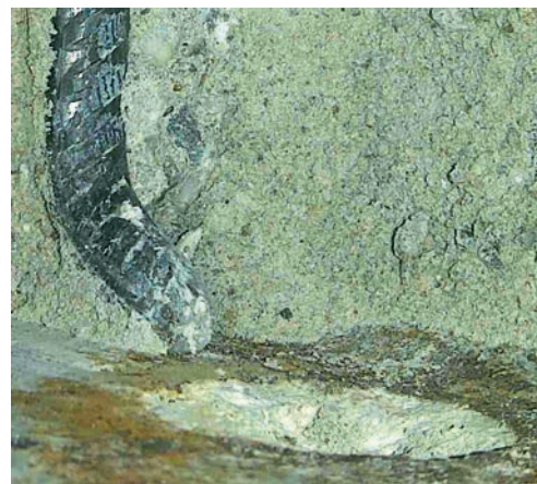
Bild 5. Verformter Bewehrungsstab nach dem Versuch Fig. 5. Shape of the deformed bar after testing
