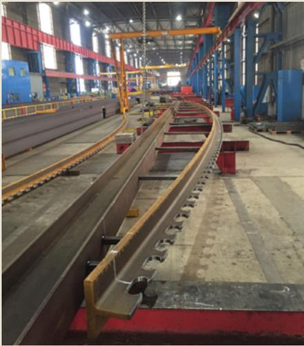
Aus Transportgründen wurden die Träger in der Länge geteilt, so dass insgesamt vier T-förmige Profile entstanden. Diese Längen konnten am Stück verzinkt werden, da die häufig verfügbaren Maximallängen der Verzinkungskessel von etwa 16 m eingehalten wurden. Jedes Profil erhielt zwei Löcher 25 mm in den Stahlzähnen als Aufhängemöglichkeit für den Verzinkungsbetrieb.
