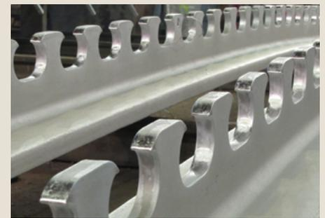
Die Nutzung von Walzprofilen mit klarer Geometrie und ohne aufwändige Schweißverbindungen ist besonders vorteilhaft im Hinblick auf den späteren Verzinkungsprozess. Während die Schnittflächen bei aus Blechen zusammengesetzten Trägern nach dem thermischen Schneiden mechanisch nachgearbeitet werden müssen, damit eine ausreichende Zinkannahme möglich ist, ist dies bei der Verwendung von Walzprofilen nicht erforderlich. Auch die Gefahr eines Verzugs aus Schweißeigenspannungen besteht nicht.
