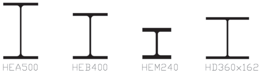
Bild 3. Vergleich von Walzprofilen mit einer Querschnittsfläche von ca. 200 cm 2 Fig. 3. Comparison of hot rolled sections with a section area of about 200 cm 2
